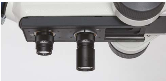
Posuvný nosič objektivů se dvěma namontovanými objektivy.
