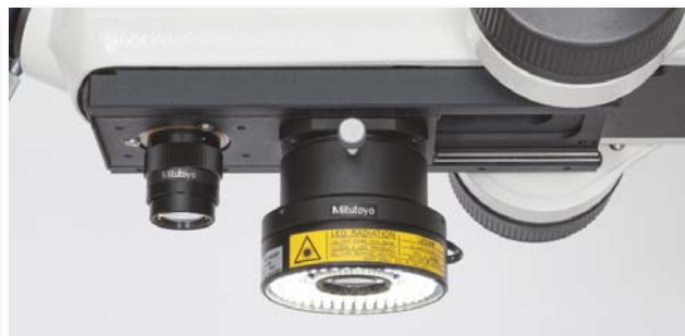
Objektiv a prstencové LED osvětlení namontované na posuvném nosiči objektivů.
